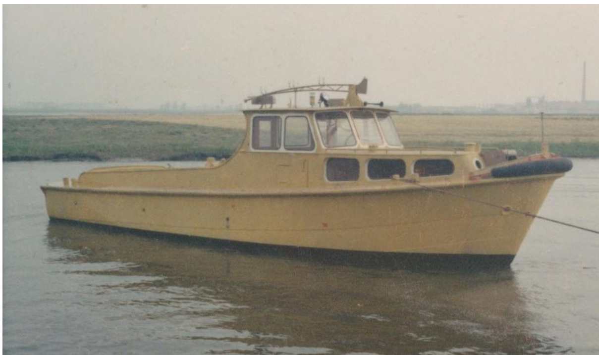
Werkboot, nog in de gele zinkchromaat grondverf, bestemd voor de Rotterdamse haven en werk op de Maas. 1965 Naar een idee van Tonny Brugman.
