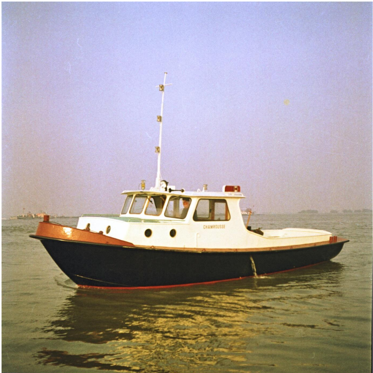
"Chamrousse" in 1966 Sleepvlet van 13 meter. Eigen ontwerp. Voor Franse rekening gebouwd via de Scheepsmakelaar Key.
