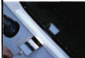
Punt van zorg: met een spiegeltje en een zaklantaarn beoordeelt de expert de verbinding tussen stalen dek en polyester opbouw.
